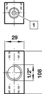
1 Mit zwei alternativen, verschlossenen G1/4 Anschlüsse
